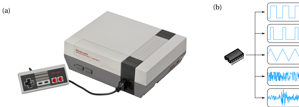
Abbildung 5.13.: Klangerzeugung der Videospielekonsole »Nintendo Entertainment System«. (a) Konsole mit einem Spielcontroller (Bild: Public Domain, [206]), (b) die fünf zur Klangerzeugung verwendeten Kanäle.
